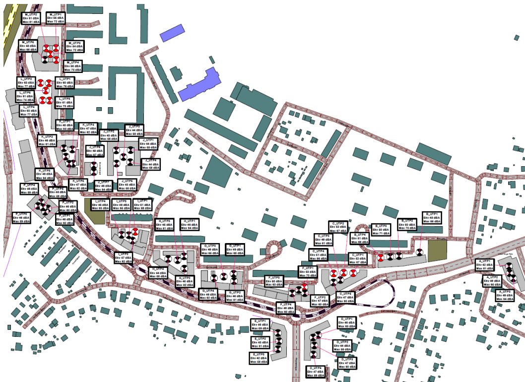
Figur 77 - Beräkningar av ekvivalent och maximal ljudnivå från alla trafikslag i området för utbyggnadsalternativet år 2040. Ljudnivå vid uteplatser är beräknade med 3 reflexer och redovisas som frifältsvärden. Beräkningar är utförda 1,5 m ovan mark. Svarta beräkningspunkter innehåller gällande riktvärden. Röda beräkningspunkter överskrider gällande riktvärden. (WSP, 2025)
