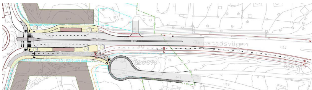
Figur 51 - Trafik - och utformningsförslag vid Tingstadsvägen Framtida utbyggnad av Tingstadsvägen illustreras i brunt. (Cowi, 2025)
